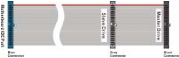
圖 2-10. Ultra DMA 66 纜線的外觀
