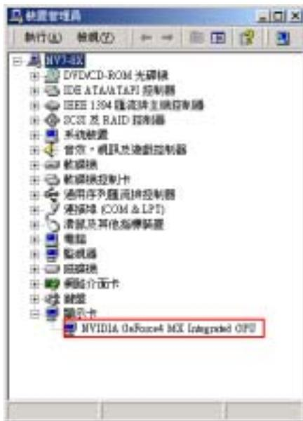
**步驟 7：** 重新啟動系統之後，在「系統內容」的選單中選擇「硬體」，然後再點選「裝置管理員(D)」。現在您應該可以看到驅動程式已經安裝並正常地運作。
