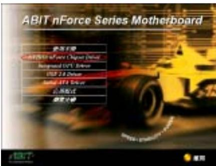
**步驟 1：** 將游標移至「NVIDIA nForce Chipset Driver」上並按一下滑鼠左鍵，進入下一個安裝步驟。
