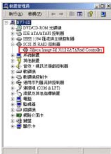
步驟 15：重新啟動系統之後，在「系統內容」的選單中選擇「硬體」，然後再點選「裝置管理員(D)」。現在您應該可以看到驅動程式已經安裝並正常地運作。
