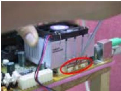
如左圖所示，您已經完成了散熱裝置的安裝。
