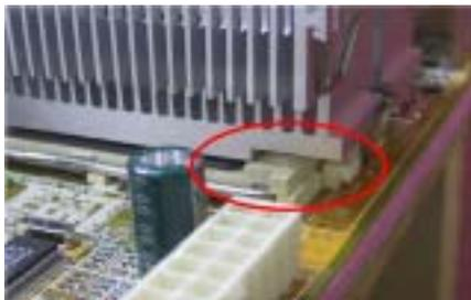
左圖顯示出散熱裝置底部右側的溝槽和 Socket 462 腳座的凸起機構部份碰觸到的情況，這時候處理器的晶片已經沒有與散熱裝置接觸，這將造成一開機處理器就會燒毀的狀況。這一點您務必要特別去注意檢查一下。
